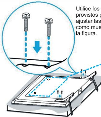
Utilice los 4 tornillos provistos para ajustar las patas como muestra la figura.
